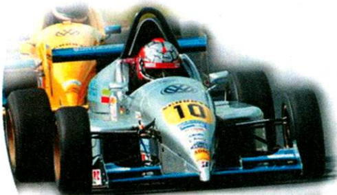
Die 415 kg schweren Renner der Formel König sind mit einem Polo 1,4 l 16 V Motor ausgestattet.
