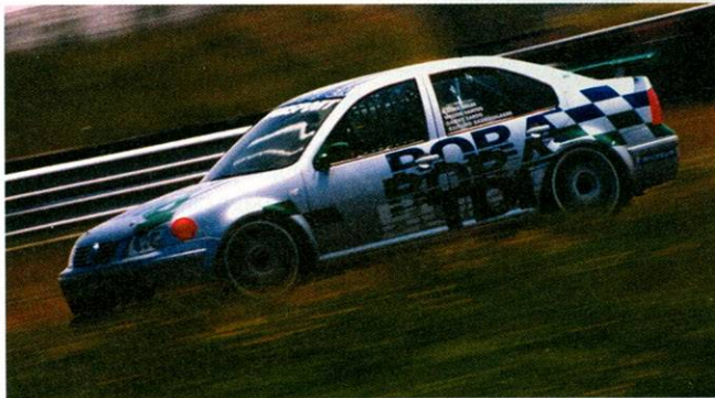
Der VW Bora R-TDI ist in der Rennversion mit einem sequentiellen Sechs-Gang-Getriebe ausgerüstet. Der neue 2,5-Liter Diesel-Direkteinspritzer leistet rund 250 PS und verfügt über ein Drehmoment von ca. 500 Newtonmeter.
